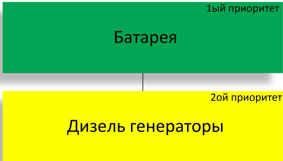
Основные потребности судна обеспечиваются аккумуляторной батареей. ДГ используются как вспомогательный источник.
