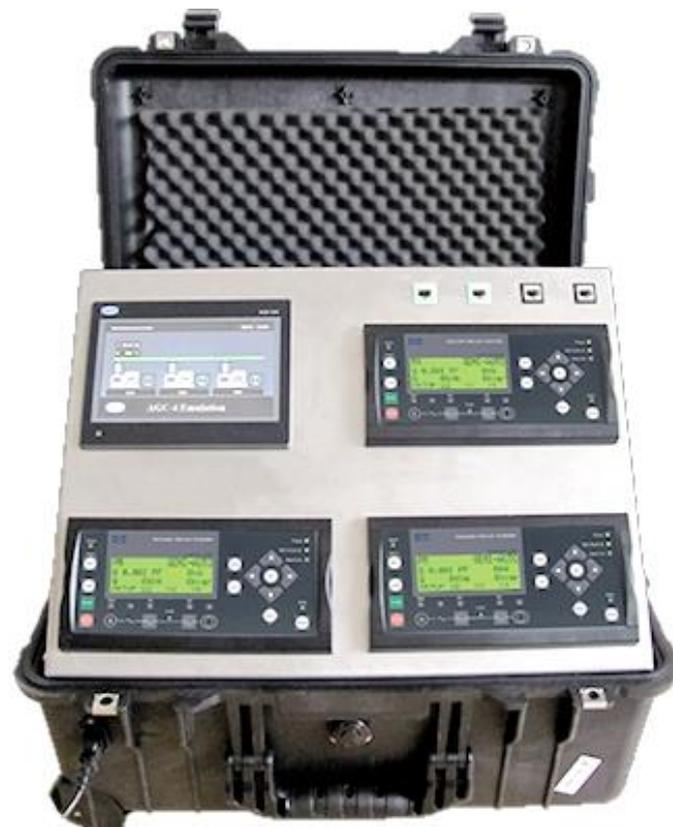
Основой для курса подготовки является тренажер судовой электростанции на базе системы PPM. Программа может включать в себя работу с контроллерами PPU, GPU, MDR, GCU, устройств серии Uni-line.
