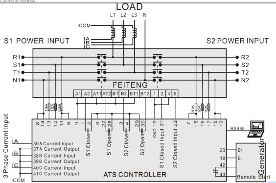
Fig. 22 Feiteng Application Diagram
