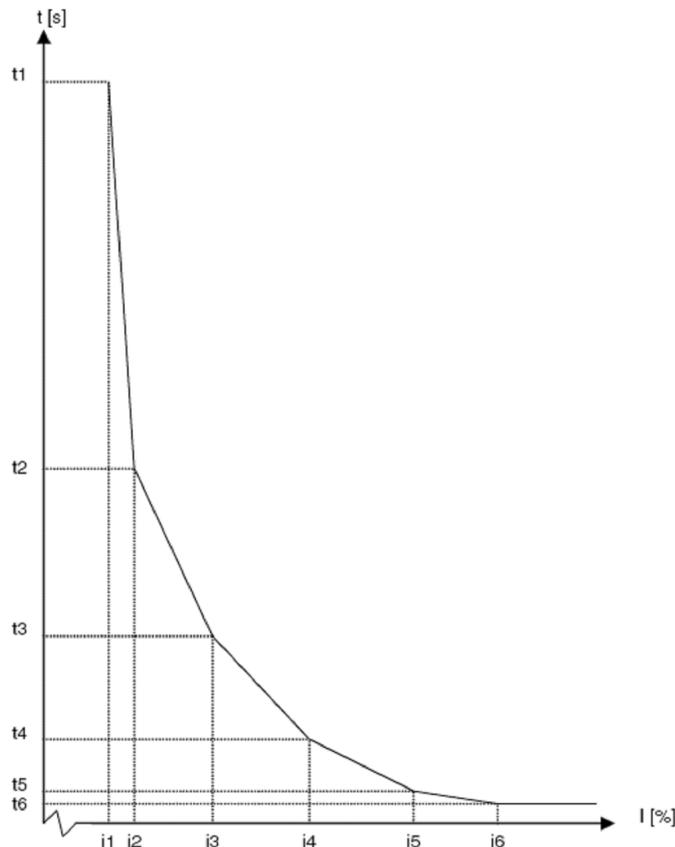
На рисунке показан пример обратной временной характеристики для защиты по максимальному току – значения  $t$  и  $i$  с индексами относятся к шести точкам уставок, которые определяют наклоны в различных участках результирующей кривой. (  $i_6, t_6$  ) и далее ( ,  $t_6$  ), кривая располагается горизонтально, т.е токам выше  $i_6$  соответствует задержка  $t_6$ .
